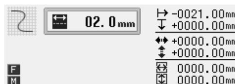
2. Introduza o comprimento do ponto com três dígitos, e pressione .
