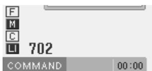
3. Insira o comprimento do ponto ziguezague com 3 dígitos, e pressione **M**.
