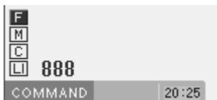
4. Pressione **1 5 0**, em seguida, pressione **F** para entrar com o percentual de redimensionamento para o eixo X. Digite o número de 3 dígitos para especificar a porcentagem de ampliação. 150% é o especificado no exemplo.
